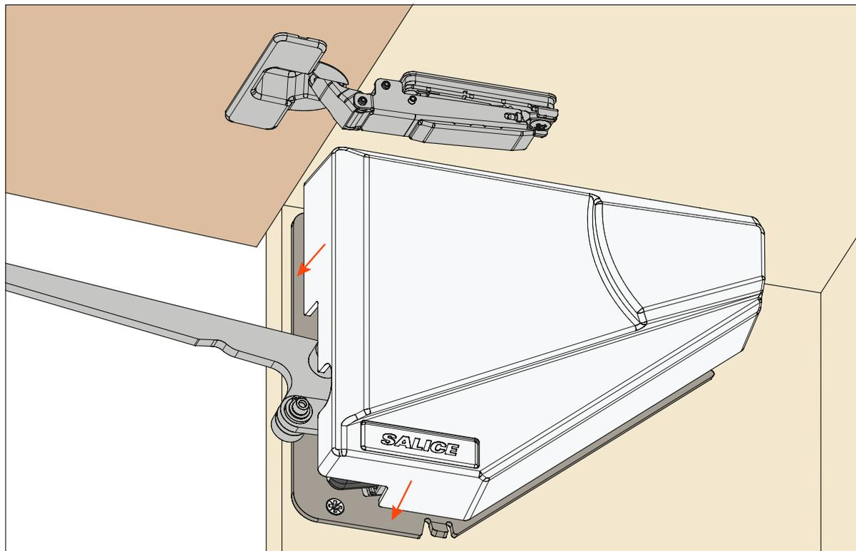
8. Подъемный механизм установлен
