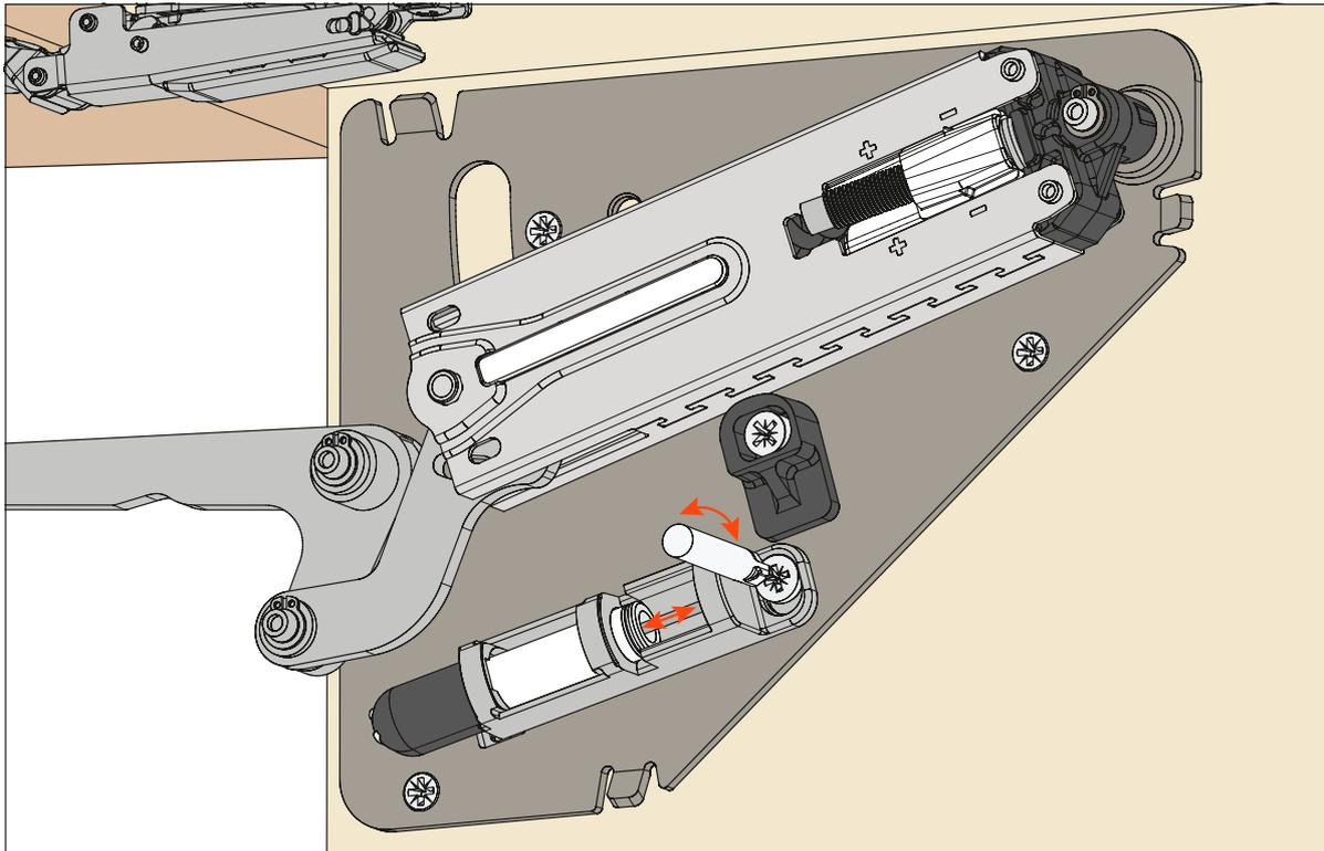
6. Производим регулировку угла открывания от 80° до 92° (используйте биты PZ2)
