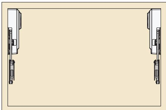
Вариант установки двух подъемных механизмов
